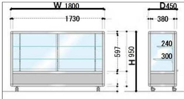
横 1800 mm × 縦 950 mm × 奥行 450 mm (内寸 : 横 1730mm × 縦 597mm × 奥行 380mm)
