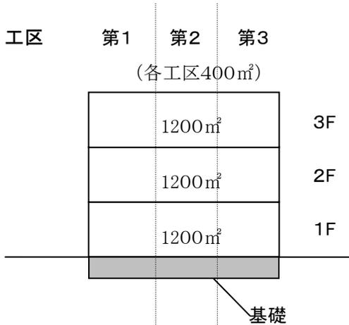
鉄筋コンクリート造3階建て建築物(各階1200m<sup>2</sup>)で、3つの工区(各400m<sup>2</sup>)に分けて工事を行う場合
