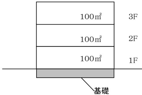
鉄筋コンクリート造(鉄骨鉄筋コンクリート造)の3階建て建築物(各階床面積 100m<sup>2</sup>)の場合
