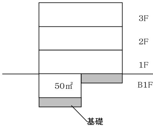
鉄筋コンクリート造の地上3階(各階床面積 100m<sup>2</sup>)地下1階(地階床面積 50 m<sup>2</sup>)建て建築物の場合
