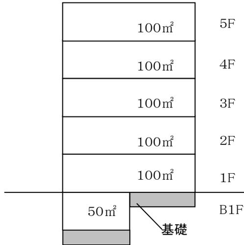
鉄骨造地上5階(各階床面積 100m<sup>2</sup>)地下
