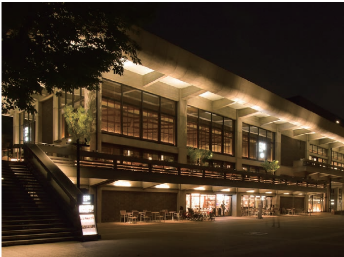
厚みのある庇が特徴の近代建築。投光器で照らすことで重厚さが印象的に。灯具は周囲から見えない位置に設置されている。
