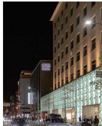
外壁を下からライトアップして通りに明るさ感を与えている事例
