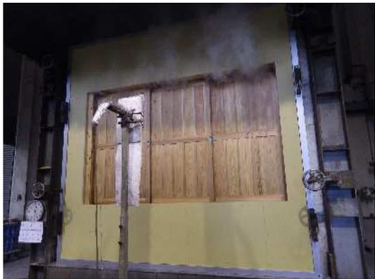
写真8 試験開始 25 分後非加熱面
