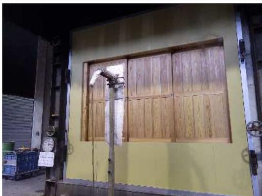
写真6 試験開始15分後非加熱面
