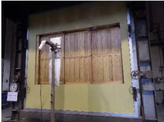
写真7 試験開始 20 分後非加熱面
