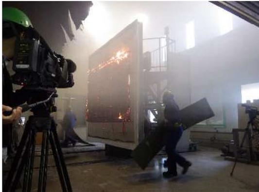
写真 10 脱炉直後加熱面
