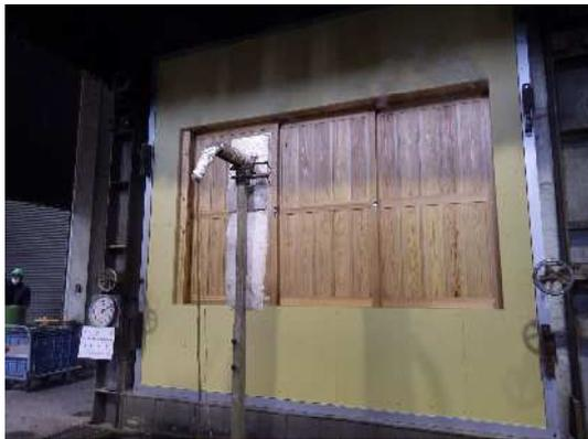
写真5 試験開始10分後非加熱面
