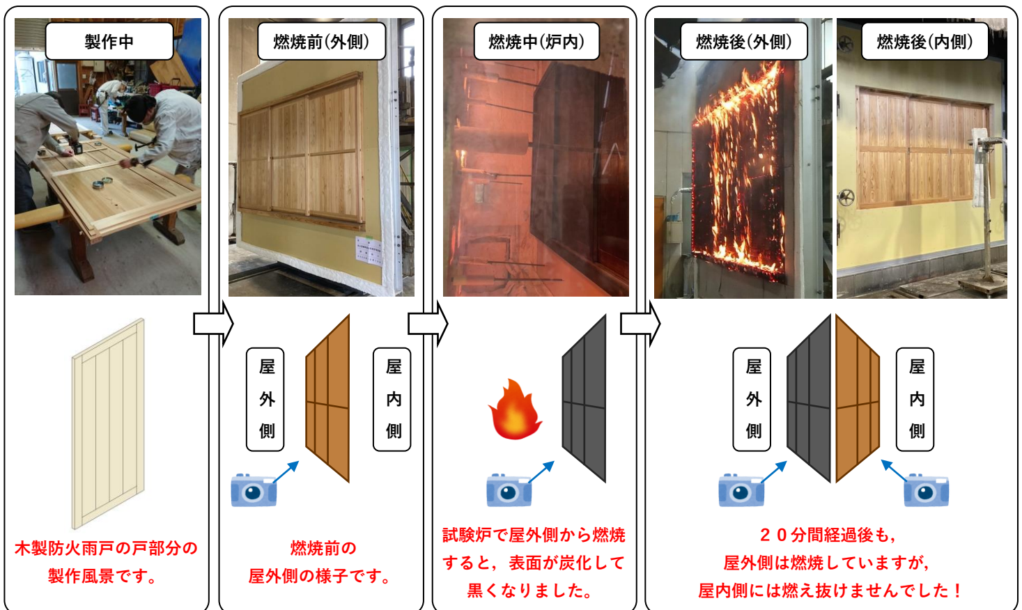
木製防火雨戸の製作から燃焼試験までの過程
