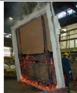
京町家の土壁防火実験
