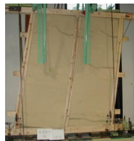
京町家の土壁耐震実験
