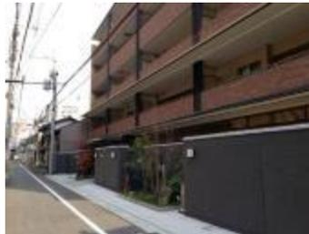
道路側から塀をセットバックさせることにより、塀の圧迫感を抑えつつマンションのプライバシーを確保し生活感が前面に出ないように配慮した。外観を構成する要素に丸瓦、格子戸、坪庭、石畳を取り入れ、京町家のイメージをデザインした。
