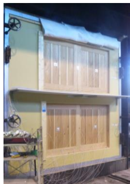
実大実験（腰窓雨戸の性能を検証）
