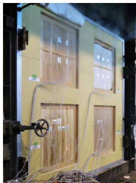
要素実験（4種類の面材の性能を検証）
