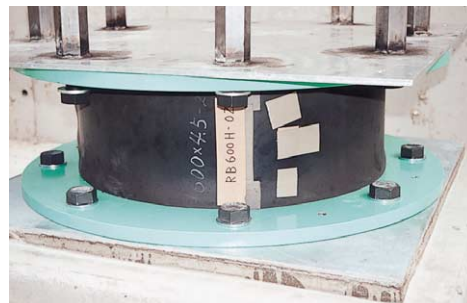
アイソレーター(積層ゴムを利用した免震装置)
