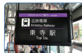
し しゅりょうちゅうおうぶ せっち 市バス車両中央部に設置する あんない 案内モニター
