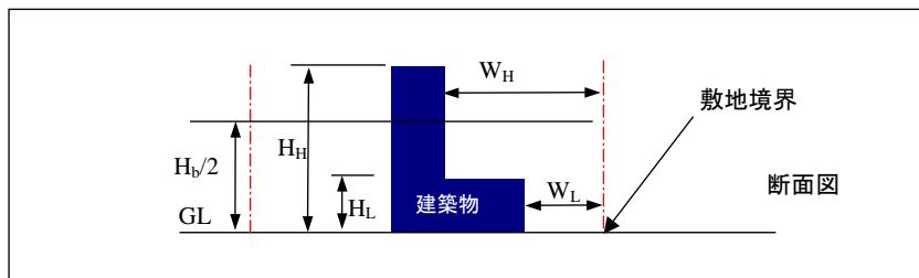
$H_b/2$ より低い位置にセットバックがある場合、風上側・風下側によらず、セットバックしている側の値は $W_H/H_H$ で評価する。
