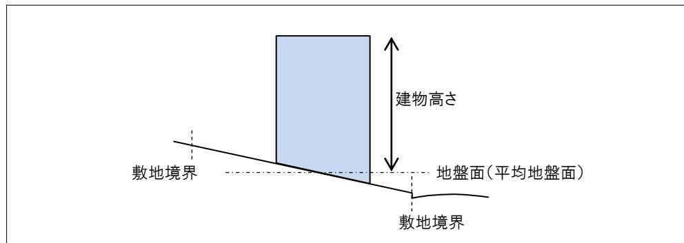
図16 傾斜地の場合の建物高さの求め方
