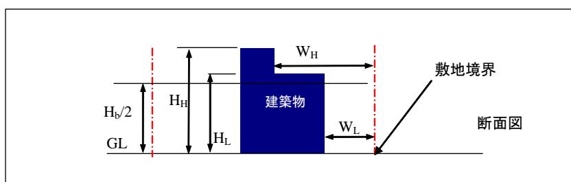
$H_b/2$ 、あるいはそれより高い位置にセットバックがある場合、風上側・風下側によらず、セットバックしている側の値は $(W_H+W_L)/2H_H$ で算出する。
