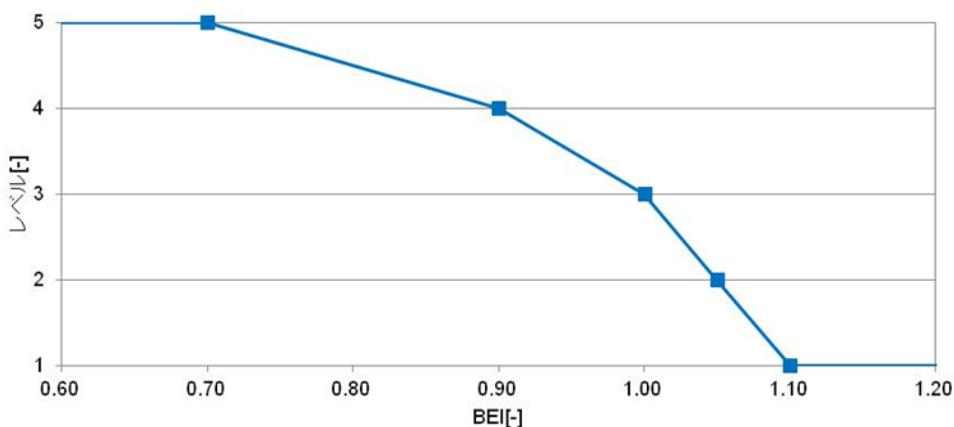
図6 すべて一次エネルギー消費量[BEI]を用いた場合のレベル評価
