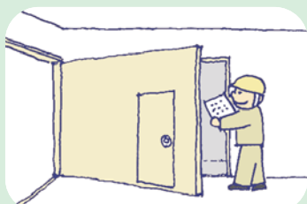
防火戸が適切に開閉するか
