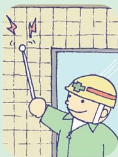
外壁タイルが剥がれかけていないか
