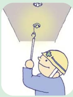
非常用照明が適切に点灯するか
