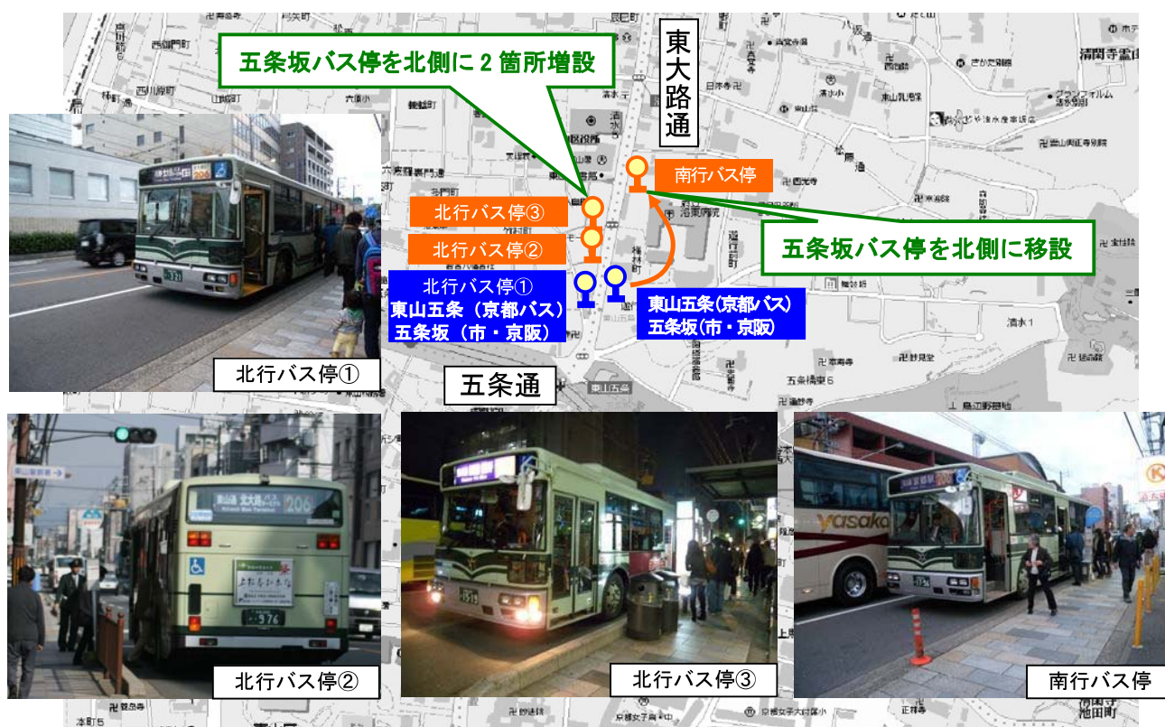
図 39 バス停の分離・移設の状況
