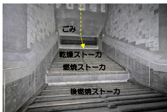
ストーカ式焼却炉の例（南部 CC）
