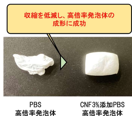
PBS 発泡体及び CNF 添加 PBS 発泡体の外観
