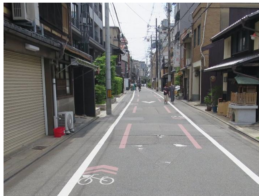
歩いて楽しいまちなかゾーンの路面表示 (自動車の速度抑制等を目的として、ベンガラの破線や実線が設置されている)
