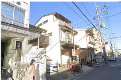
No.233 3階建の戸建住宅。1階を駐車スペースとし、セットバック距離は小さい。
