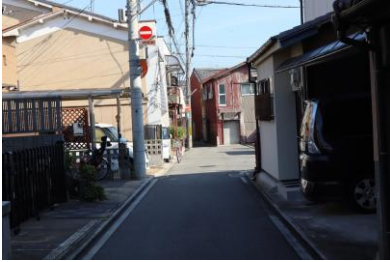
E-pt18：A-3)D/H 沿道の2階建・戸建住宅が連続してセットバックし(No.94,96,98)、D/Hの値が大きくなる。
