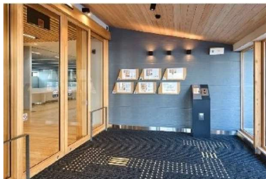
・点字ブロックや音声案内を設けた エントランス
