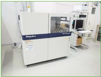
新材料・新製品の研究開発や品質向上等の改善の向けた活用ができる「蛍光X線分析装置」
