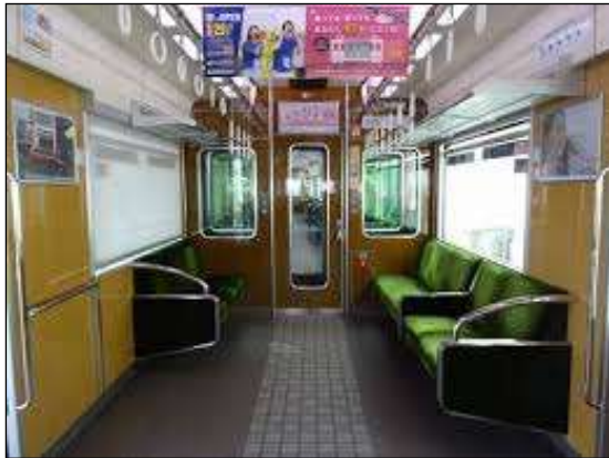
車両改造時に車いすスペース設置(1 箇所/1 車両)
