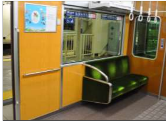
車両改造時に車いすスペース設置(1 箇所/1 車両)
