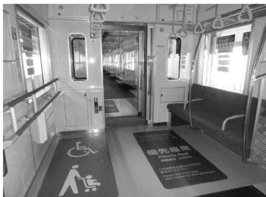
バリアフリー法に基づく移動等円滑化基準（1編成 2箇所以上）を大きく上回る設置数（計 12箇所（うち 2箇所はおもいやりエリア））とし、車椅子で移動される方、高齢の方など誰もが利用しやすいように、出入口から連続する 2段手すりを設置しました。
