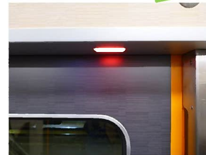
側引戸開閉予告灯
