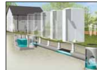
災害用マンホールトイレ
