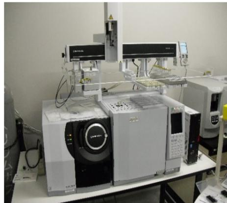
自動前処理型ガスクロマトグラフ質量分析装置
