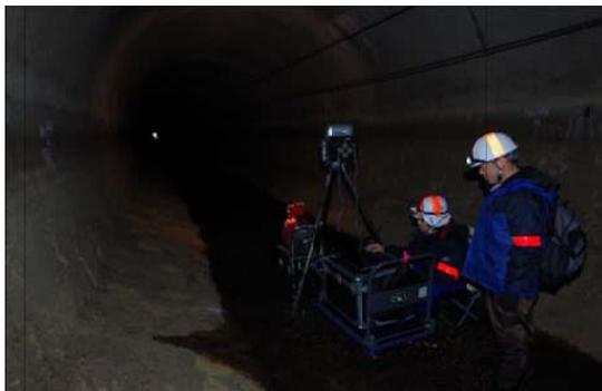
写真-3 3Dレーザー測定状況
