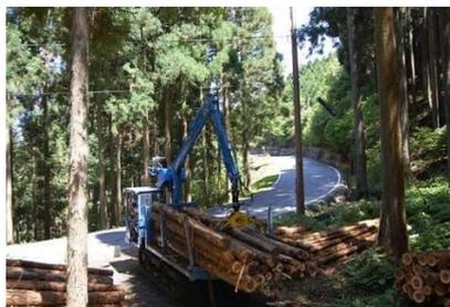
林内路網と高性能林業機械による間伐材の搬出
