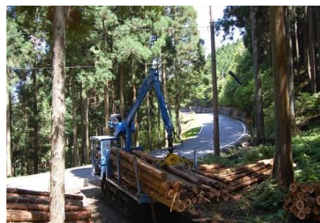
林内路網と高性能林業機械による間伐材の搬出
