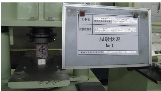
コンクリートコアの圧縮強度試験の様子
