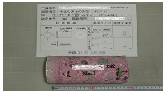
コンクリートコアの中性化試験の様子
