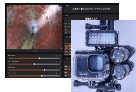
AIによる劣化判定(左) 高画質管口カメラ(右)
