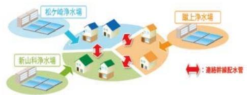
連絡幹線配水管による給水のバックアップ機能の強化イメージ
