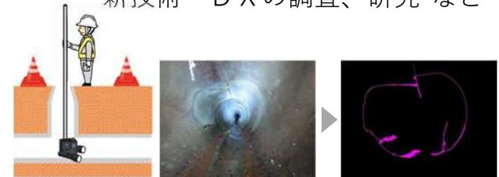
高解像度カメラを用いた管口カメラ調査
