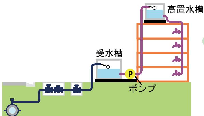
受水槽に貯めた水をポンプで高置水槽にくみ上げ、自然流下により給水する方式
