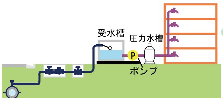
受水槽に貯めた水をポンプで圧力水槽に貯え、その内部圧力により給水する方式
