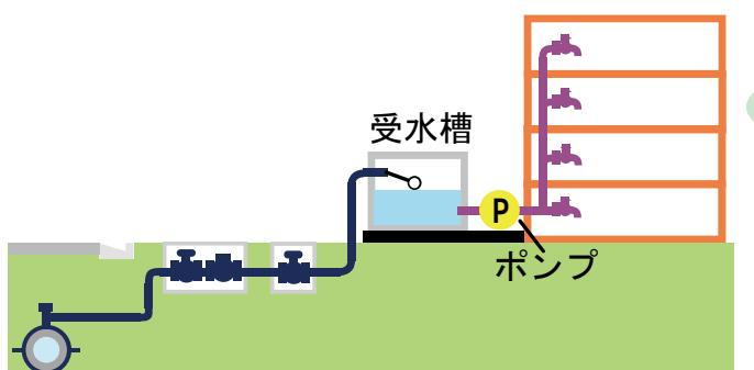
受水槽に貯めた水をポンプにより給水する方式
