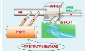
貯留管による対策イメージ
