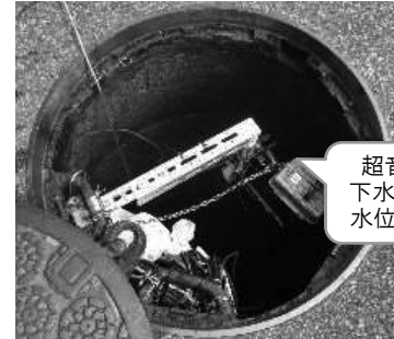
マンホールに設置した水位計測機器
