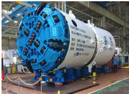
新山科浄水場導水トンネル築造工事 (シールド掘進機)
