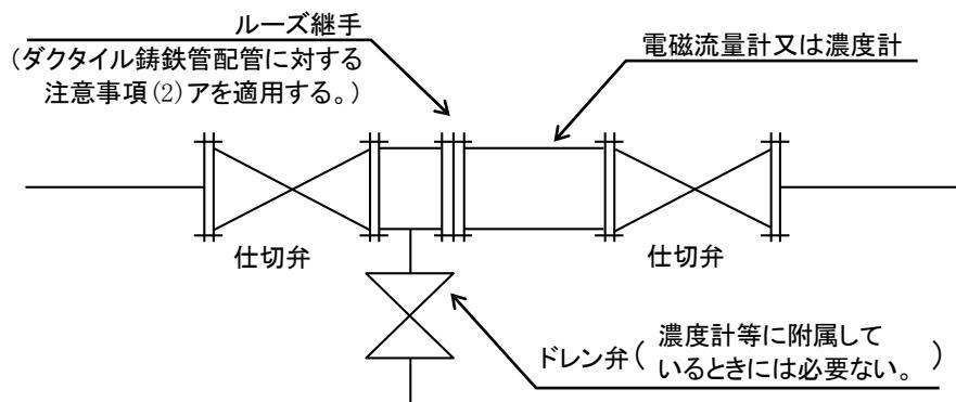
図3-3 ドレン管、ルーズ継手の例
