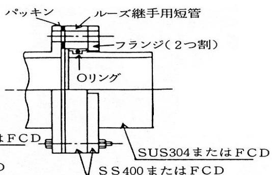
図 2-1 ルーズ継手の例
