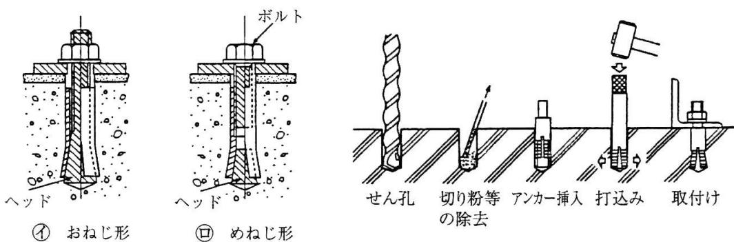
図 1-1 メカニカルアンカーの形状例
