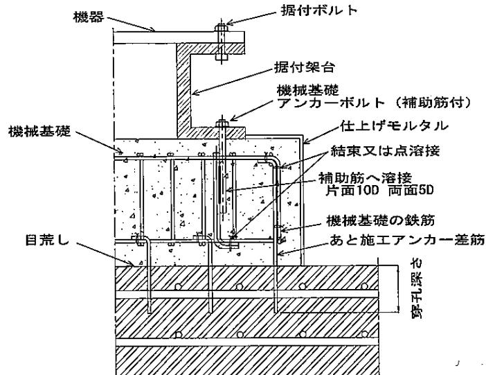
図 1－5 (2) 基礎の連結の例（後打ち工法）
