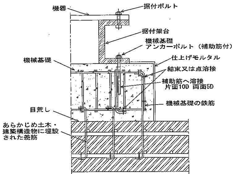
図 1－5 (1) 基礎の連結の例 (先付け工法)
