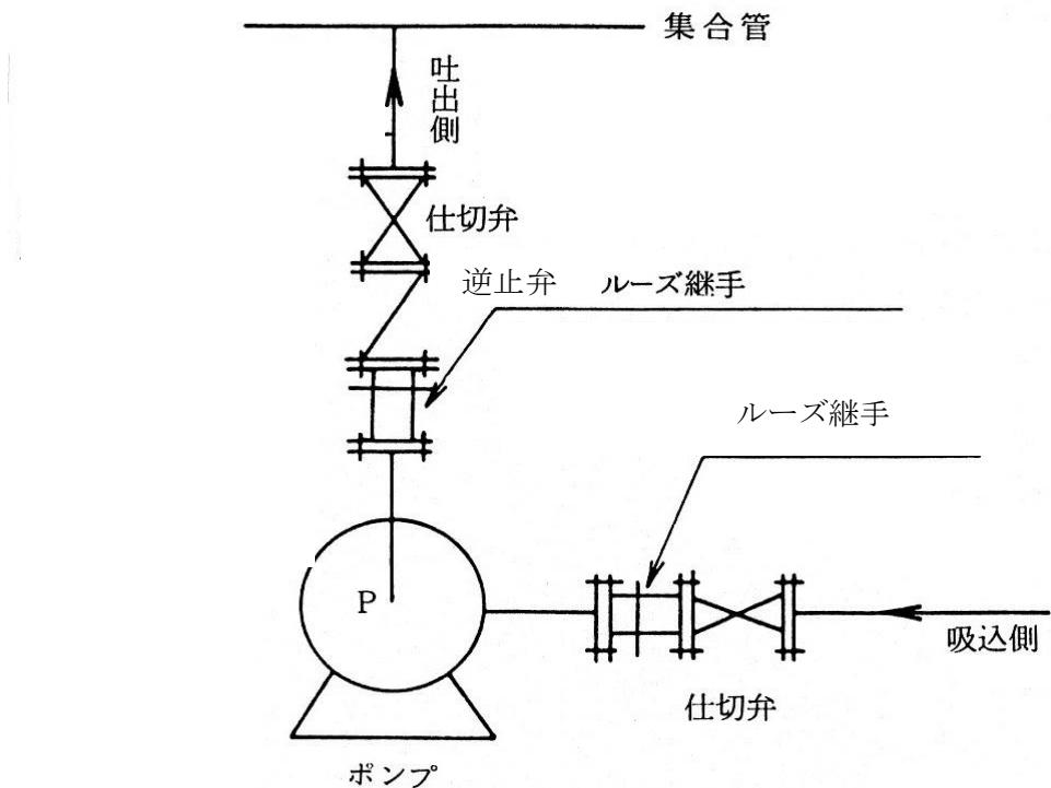
図 2-2 ポンプ廻りの配管の例
