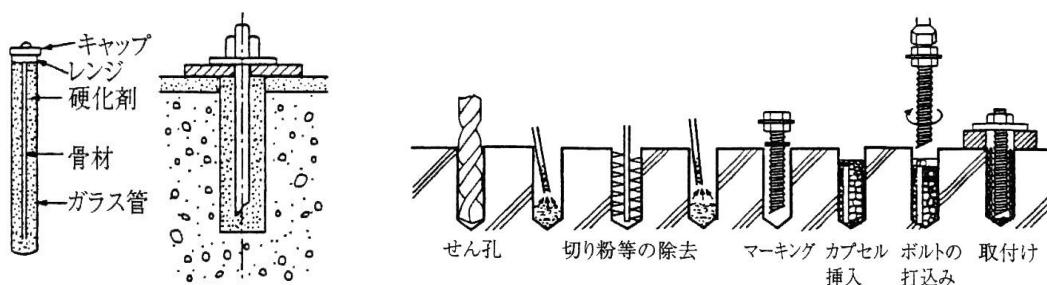
図 1-3 接着系アンカーの形状の例
