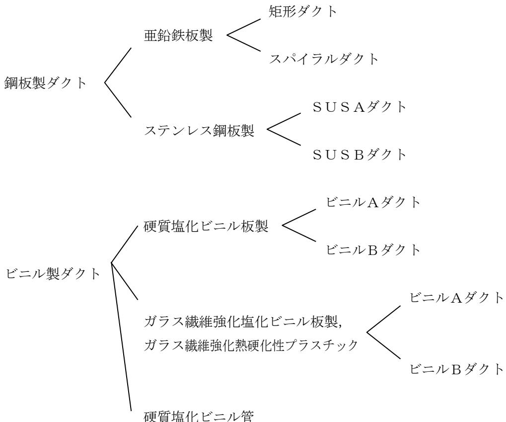
SUS Aダクト：ステンレス鋼板製ダクトのうち、鋼板、法兰ジ、つり金物等がすべてステンレス製のもの。
