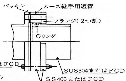
図2-1 ルーズ継手の例
