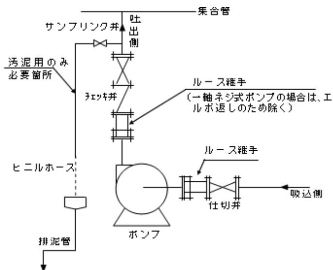
図 3-5 ポンプ廻りの配管の例
