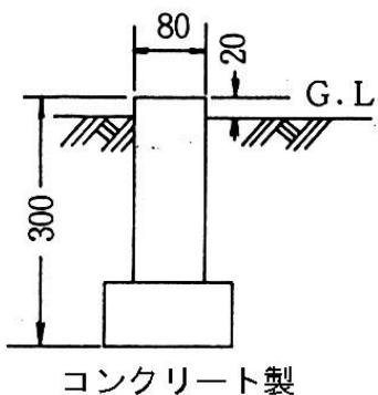
図は舗装していない場合を示しており、舗装した場合は舗装面に合わせる。また、草刈や除雪作業への支障がないように配慮する。
