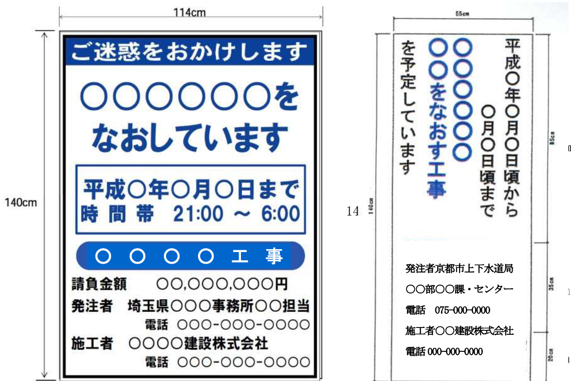
図 1-1-2 工事標示板記載例
