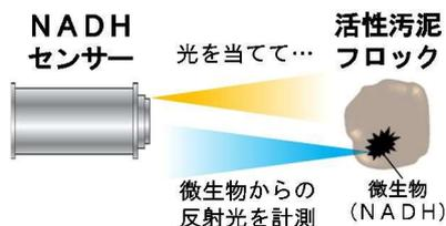
NADHセンサーにより、微生物にとって必要な空気量を制御することで、下水処理の効率化につながります。
