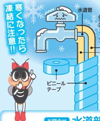
冬場は気温が下がり、水道管が凍結したり、破裂する等の事故が発生しやすくなります。浴槽などに少しずつ水を出しておくことで凍りにくくなります。また、図のような防寒対策が有効です。
