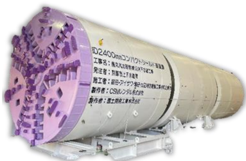
鳥丸丸太町幹線公共下水道工事シールドマシン (下水道管を布設するために、地中を掘削していく機械)
