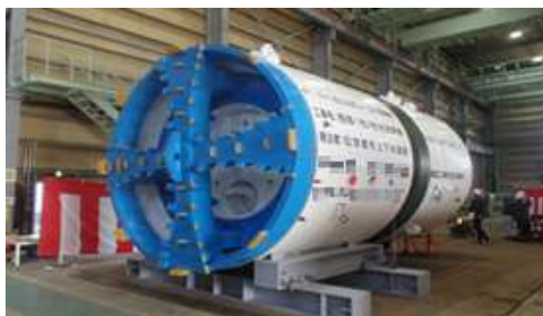
西部1号2号分流幹線（その1）公共下水道工事シールドマシン（下水道管を布設するために、地中を掘削していく機械）
