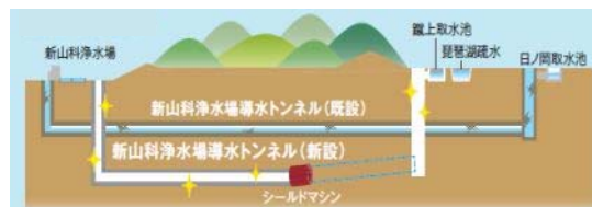
新山科浄水場導水トンネルの更新・耐震化
