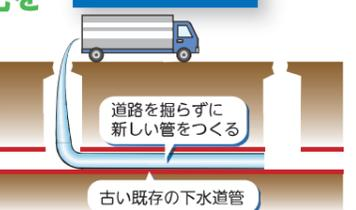
古い管を新しい管に入れ替える開削工法のほか、掘らずにマンホールから工事ができる更生工法(古い管の内側に、新しい管を作る工法)により、更新と耐震化を進めています。
