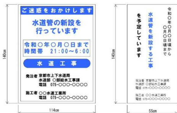
図－1 工事標示板記載例
