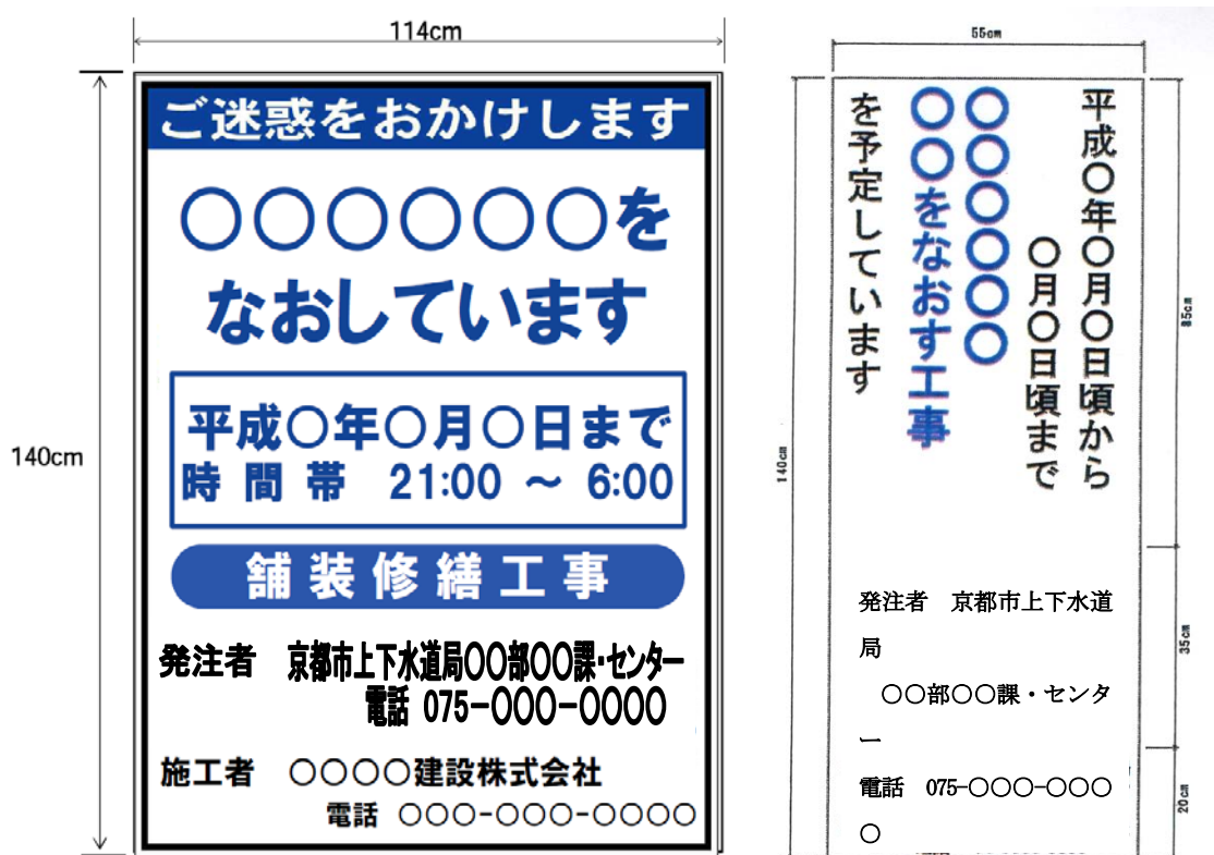
図1-1 工事標示板記載例
