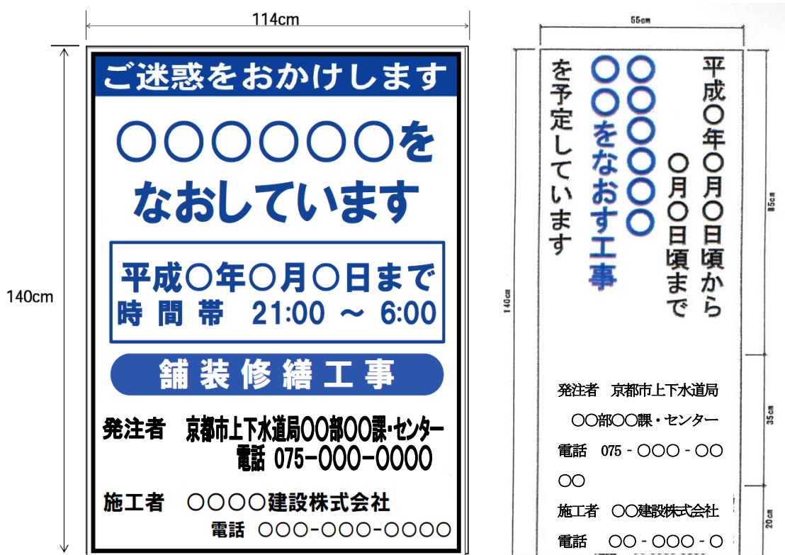
図 1 - 1 工事標示板記載例
