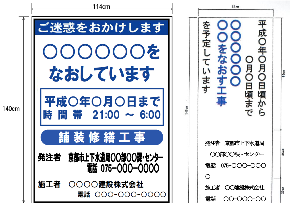
図1-1 工事標示板記載例
