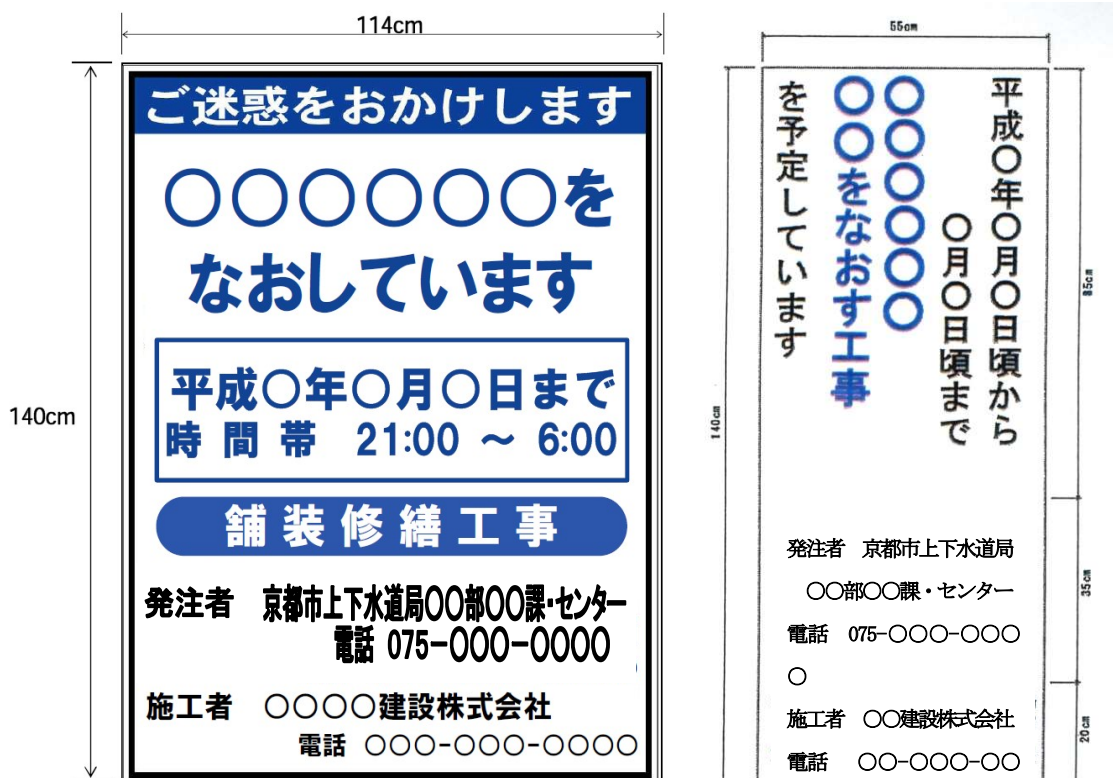
図1-1 工事標示板記載例
