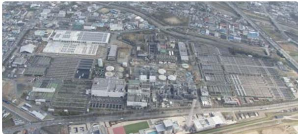
昭和14年に運転を開始した京都市最大の下水処理施設であり、全国有数の処理能力を有します。りんや窒素を除去する高度処理を導入し、大規模太陽光発電設備も設置しています。他の水環境保全センターの下水汚泥も全てここで集約処理し、有効活用を積極的に推進します。また、120メートルに及ぶ藤棚の名所としても有名です。
